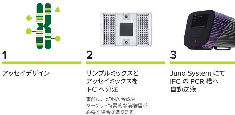
Figure 3. Juno System および Biomark HD System プラットフォームを使用した PCR および NGS ベースのアプリケーション向けのワークフロー例 Juno System は、Biomark HD System での検出や NGS ワークフローで GBS のアンプリコンライブラリの準備に使用可能です。
