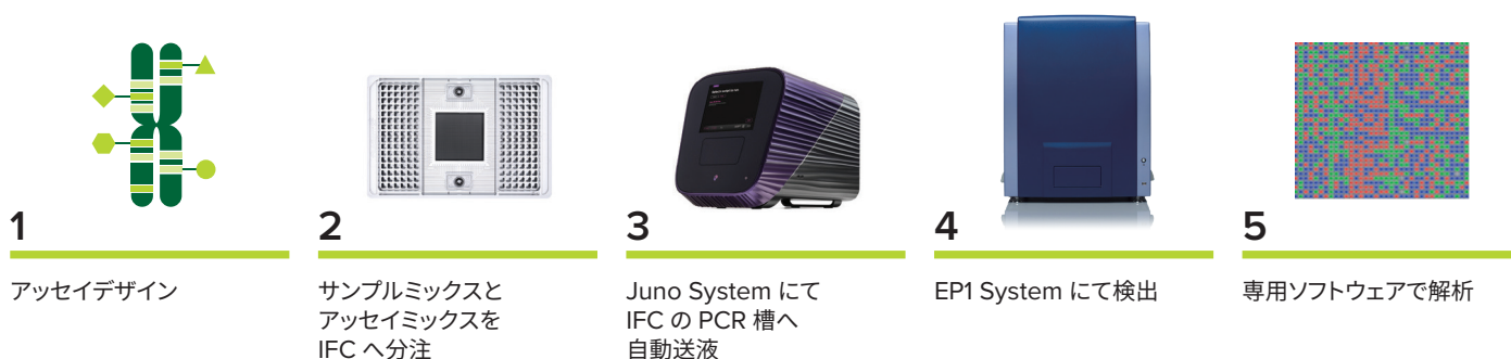
Figure 2. Juno System および EP1 System を使用したアプリケーションワークフロー
